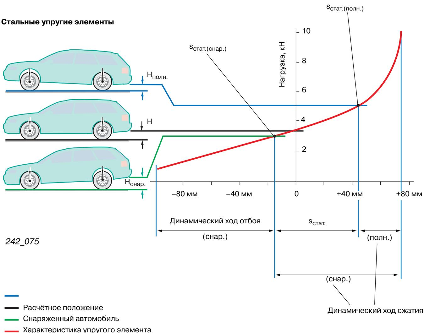
$H_{\text{полн.}}$  = высота при полной нагрузке
