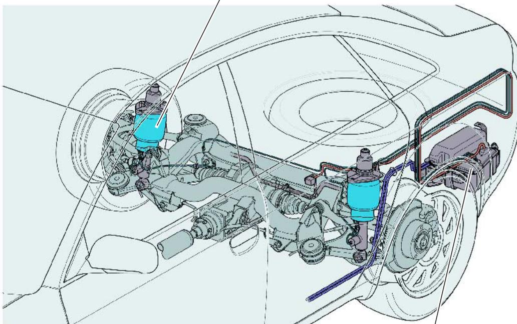
Пневматический упругий элемент с амортизатором PDC
