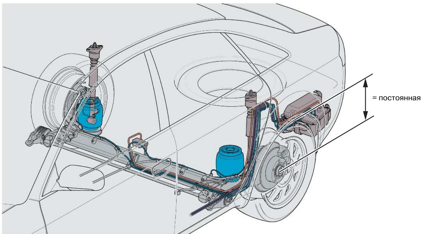
Неизменное (расчётное) положение кузова автомобиля (поддрессоренной массы) поддерживается путём регулировки давления в пневмобаллонах.
