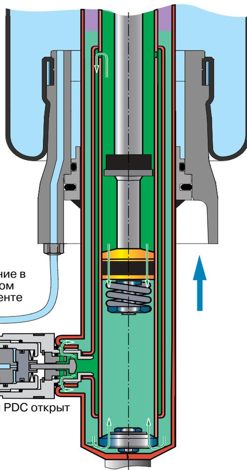
Низкое давление в пневматическом упругом элементе
