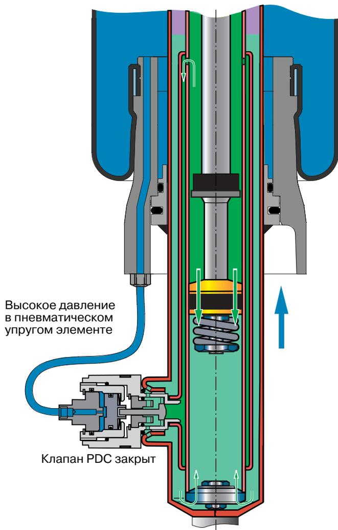
Высокое давление в пневматическом упругом элементе
