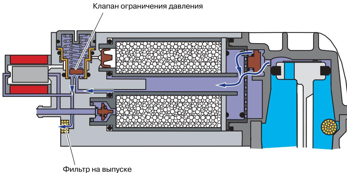
**Схема пневматической системы при срабатывании клапана ограничения давления**
